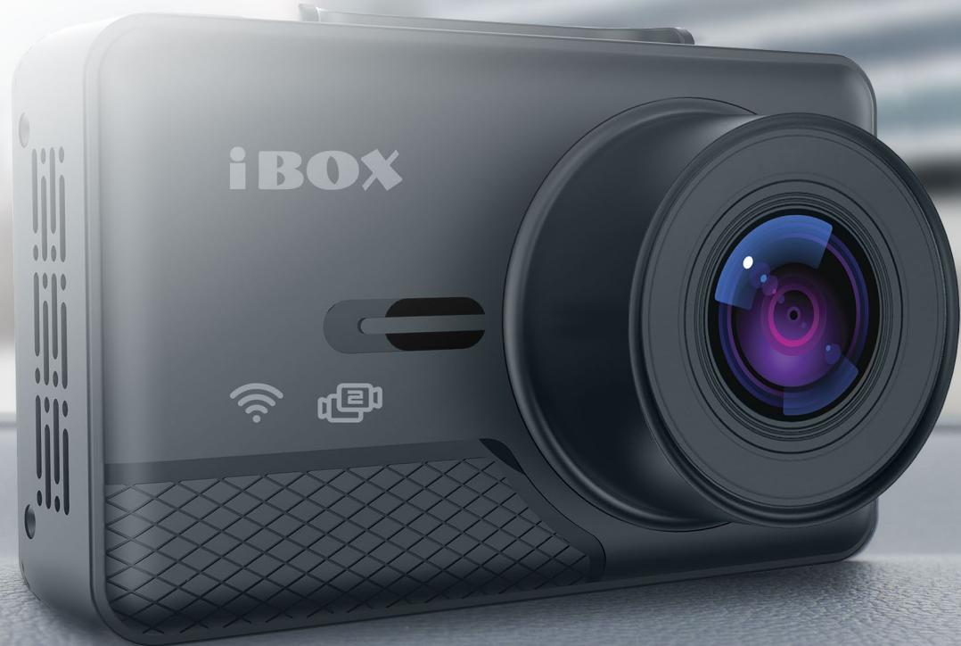
**iBOX Travel WiFi GPS Dual** – новейший Full HD видеорегистратор с GPS/ГЛОНАСС, камерой заднего вида, возможностью копирования файлов по WiFi и функцией «Помощь при движении назад».
