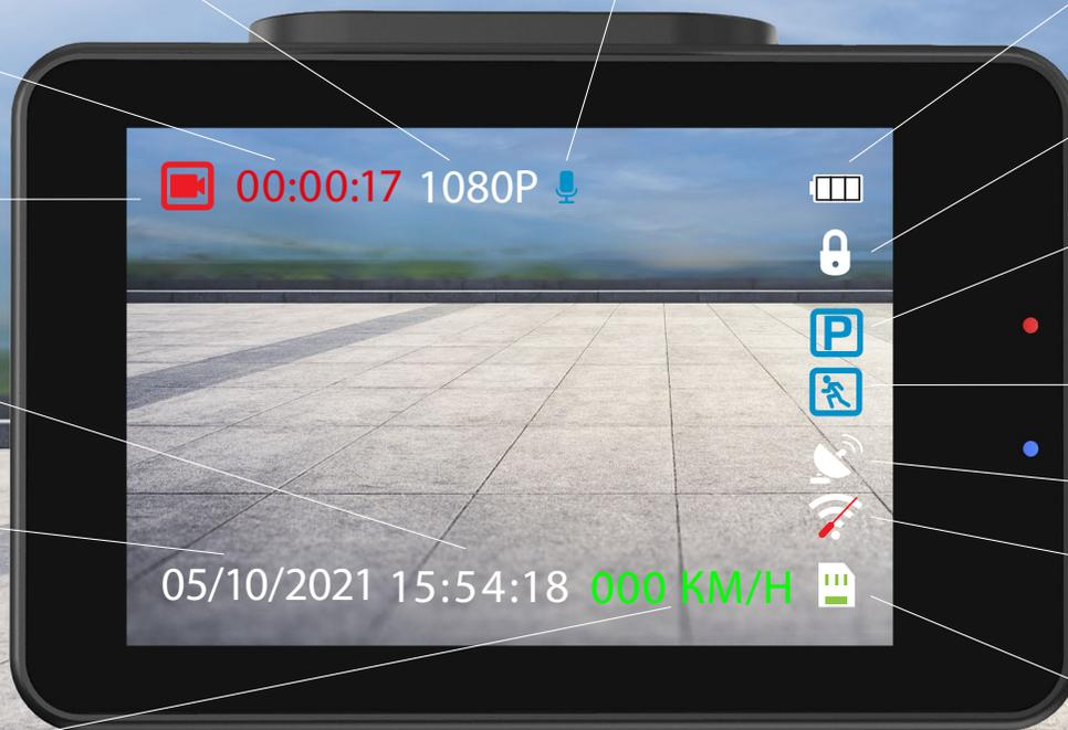
Яркий **IPS дисплей** высокого разрешения с диагональю **2,4"** отлично читается под любым углом. Он позволяет производить настройку устройства и отображает всю информацию, необходимую для контроля видеозаписи.
